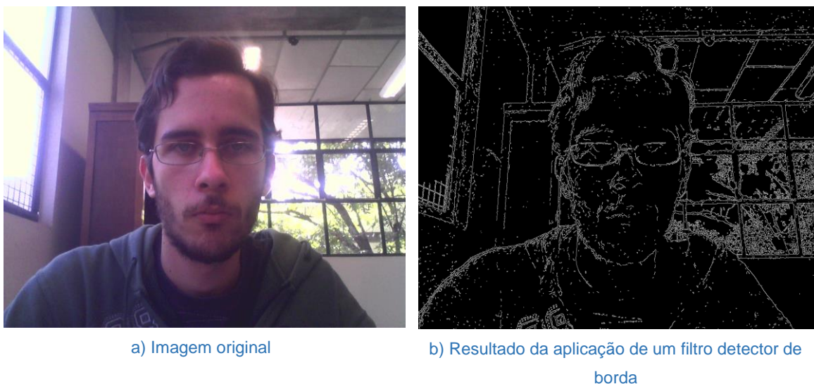
Figura 40: Imagem antes e após a aplicação do processamento de imagem
