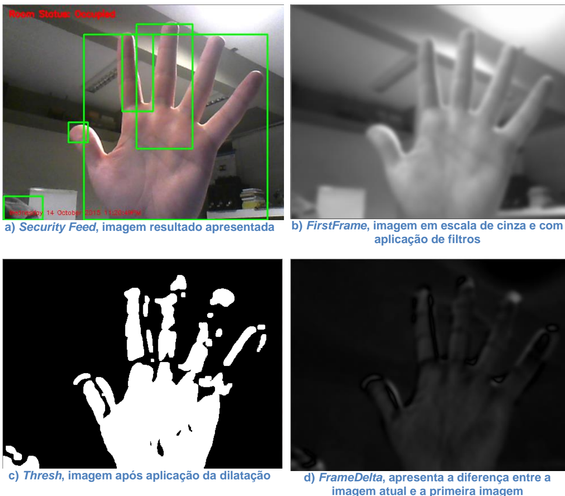
Figura 41: Resultado do processamento de imagem com o algoritmo apresentado em Algoritmo A – 4 (Apêndice)
