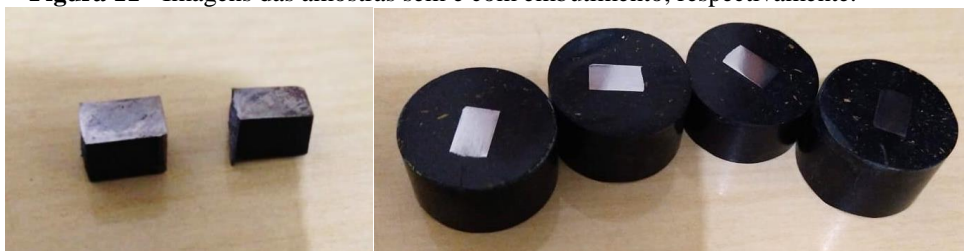
Figura 11 - Imagens das amostras sem e com embutimento, respectivamente.
