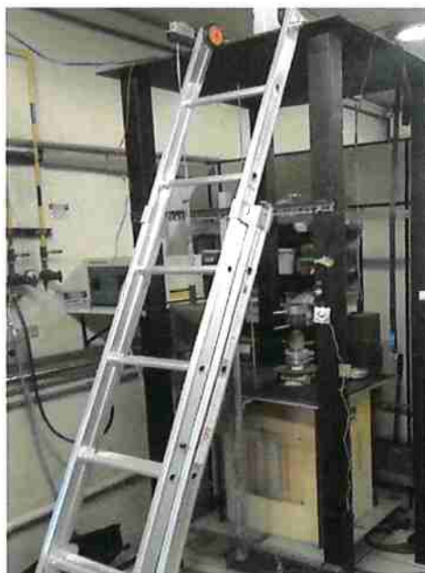
Figura 16: Visão geral do sistema do experimento. Vista do forno de resistências, sistema de contrapesos e escada que dá acesso a balança de precisão no topo da estrutura.
