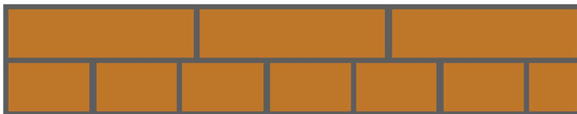
Figura 21 - Orientação da camada tijolos do piso do forno.
