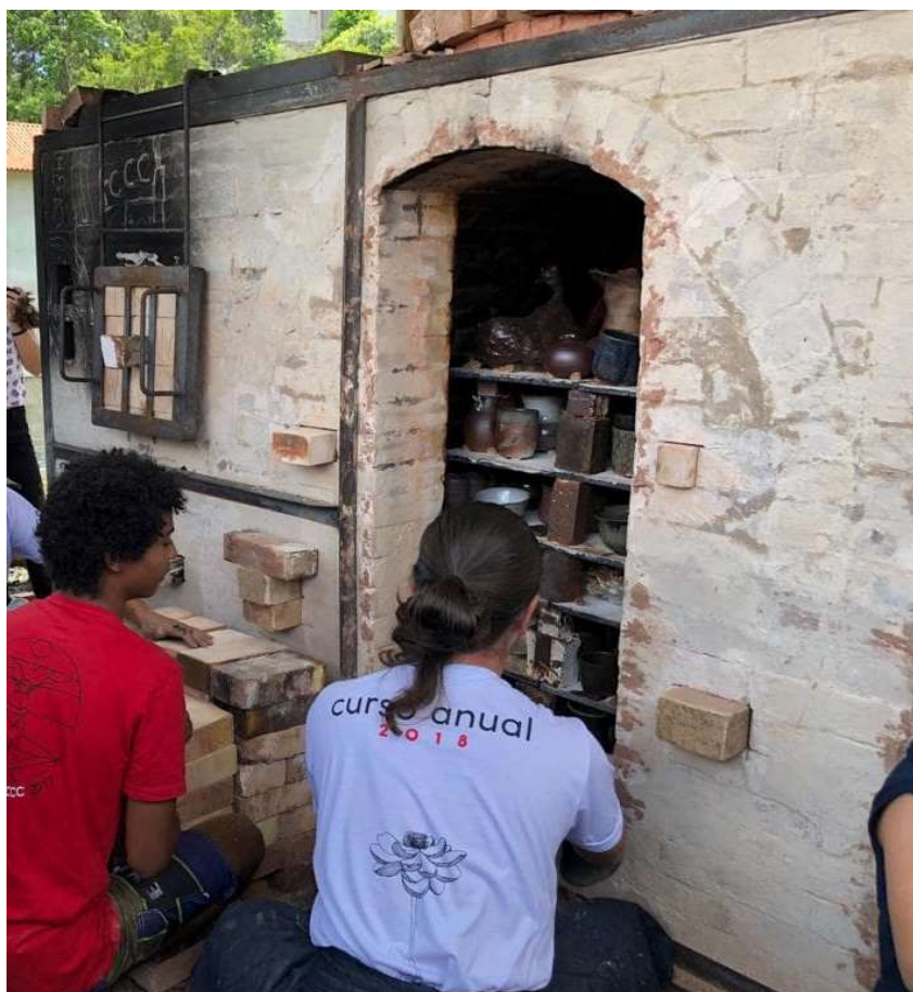
Figura 17 - Abertura pós queima do Sasukenei Smokeless Kiln em Cunha – SP.
