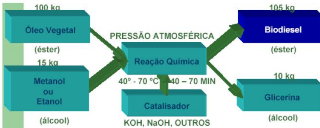
Figura 12 - Fluxograma de massa, no processo de transesterificação (PENTEADO, 2005).
