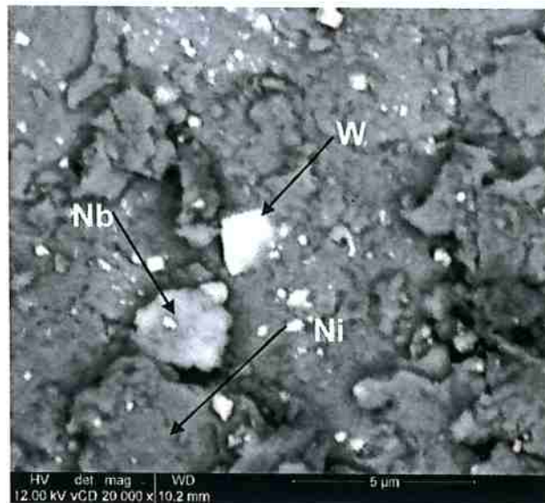
Figura. 28. Microscopia com elétrons retroespalhados, magnificação 20.000X da liga NiNb após 30 min de moagem intensiva.
