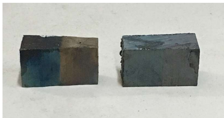
Figura 18 - Amostras retiradas do forno. A da esquerda estava no cadinho fechado e a da direita no aberto
