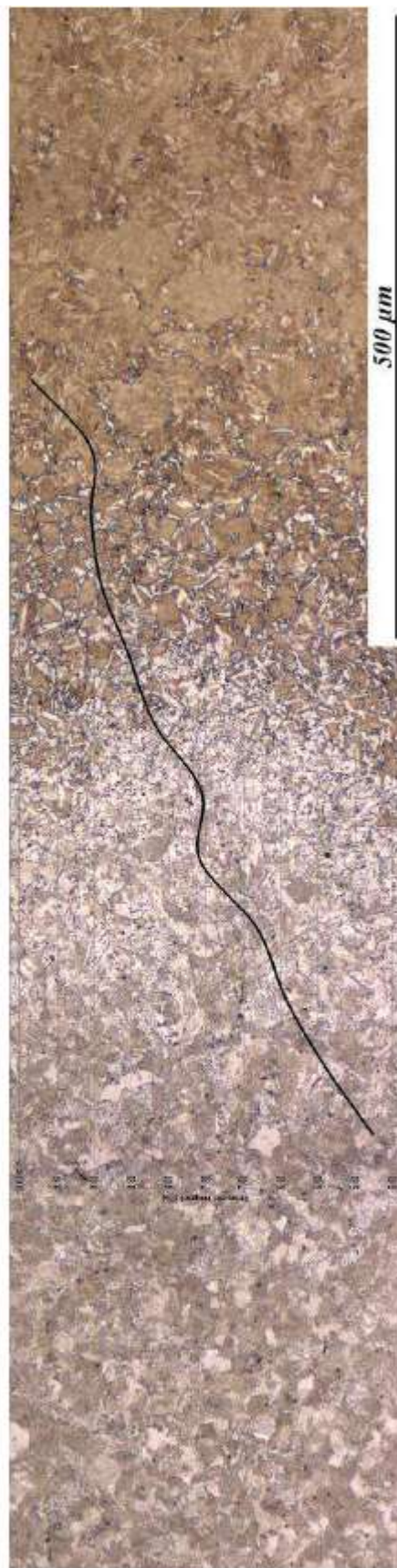
Figura 24 - Amostra após tratamento térmico. A linha no meio apresenta a variação da concentração de carbono
