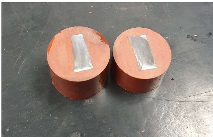
Figura 20 - Amostras após terem passado pelo processo de lixamento. A amostra da esquerda era a do cadinho fechado e a da direita do aberto
