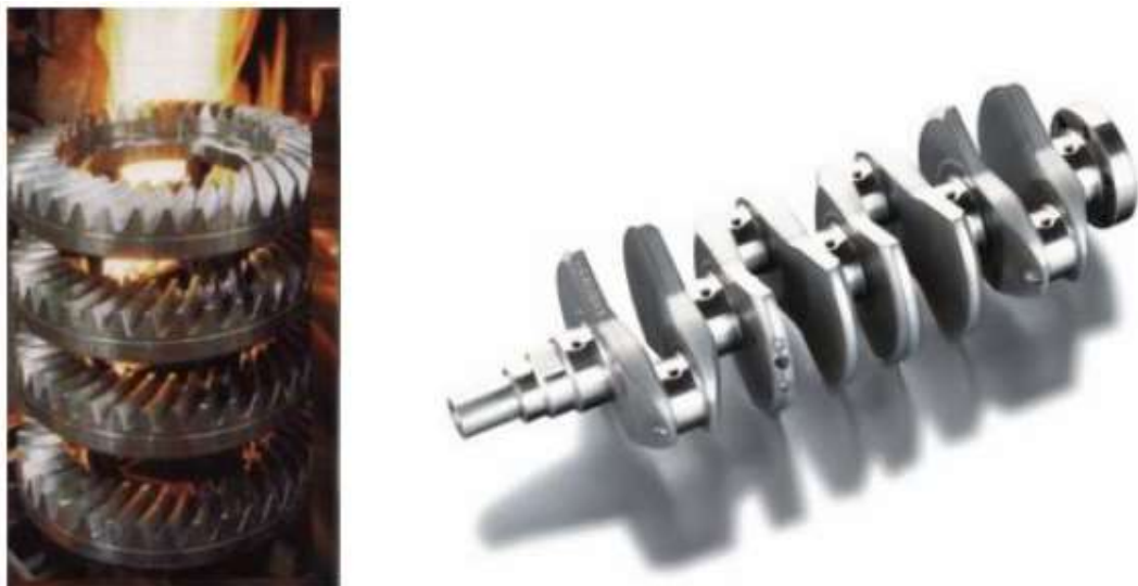
Figura 2 - Exemplo de peças de motor que passam pelo tratamento térmico, à esquerda, engrenagens, e à direita, um virabrequim
