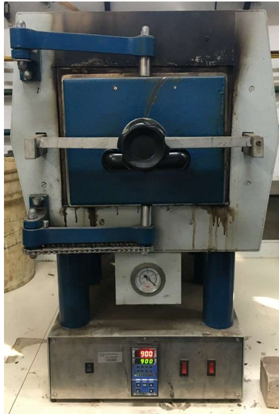
Figura 17 - Forno utilizado para o processo de carbonetação das amostras
