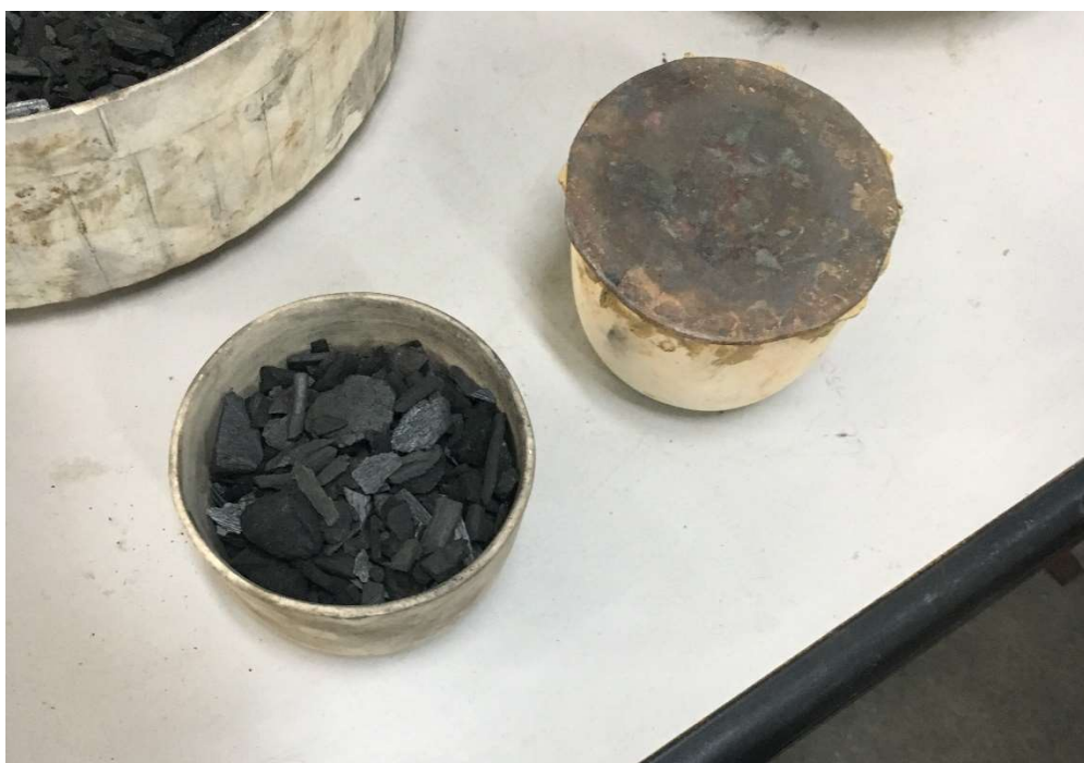
Figura 16 - Cadinhos preparados para o tratamento térmico. O da esquerda permaneceu aberto durante o processo
