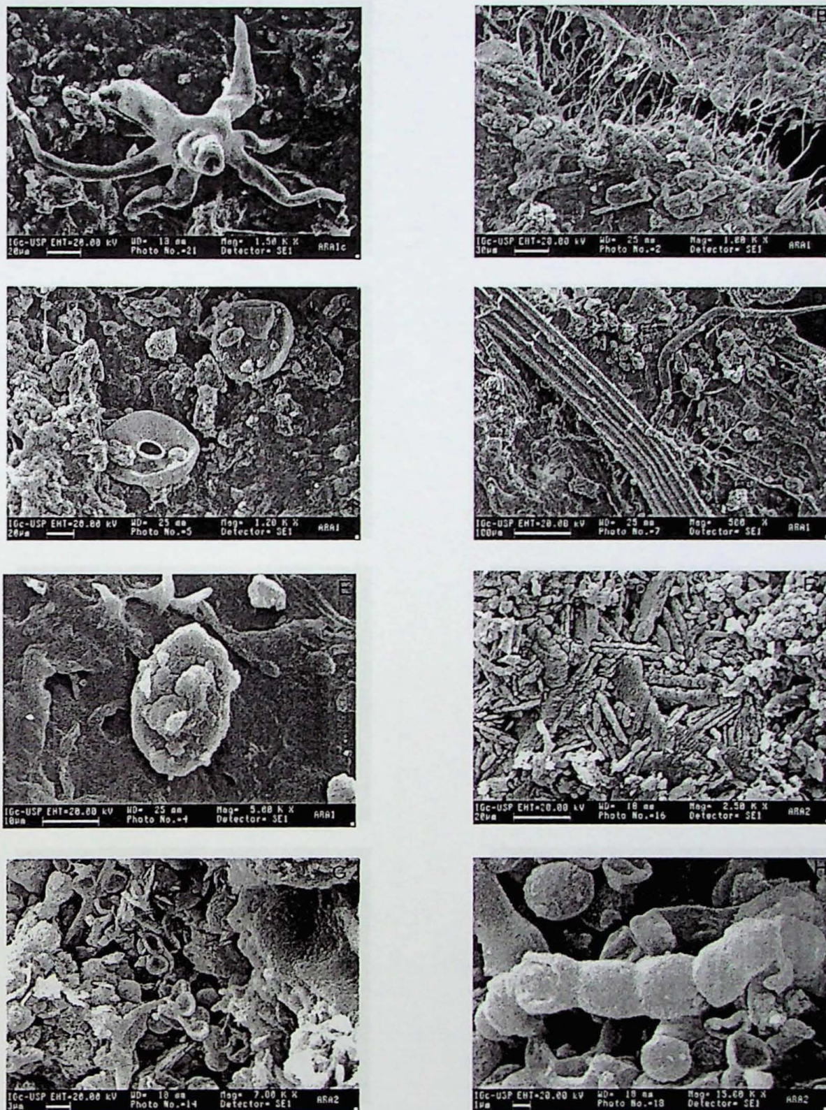
FIGURA 5: Imagens de elétrons secundários obtidas no MEV. A a E são imagens de fuligem coletada da Nostalgia. F a H são deposições superficiais coletadas em O Ceifador. Com exceção da imagem apresentada em A, as imagens são oriundas de amostras metalizadas com ouro. A – Possível estrutura biológica. EDS apontou Ca, O, Si e Al. B – Cianobactéria, filamentos de fungos e cristais de calcita. EDS apontou C, Ca, O e K. C – Esporos. EDS apontou O, Si, Fe, Al e Ca. D – Fibra vegetal posterior à formação da cobertura microbiológica. EDS apontou C. E – Ramificações na parte superior, possivelmente de um líquen. EDS apontou C, O, Fe, Al, Si e K. F – Cristais de gipsita e esporos de fungos. G – Detalhe do esporo de fungo. EDS apontou C, Ca e O. Em EDS geral da amostra, também aparece Si e S, este com sinal bastante nítido. H – Esporos, característica estrutural do fungo. EDS apontou C, Ca e O.
