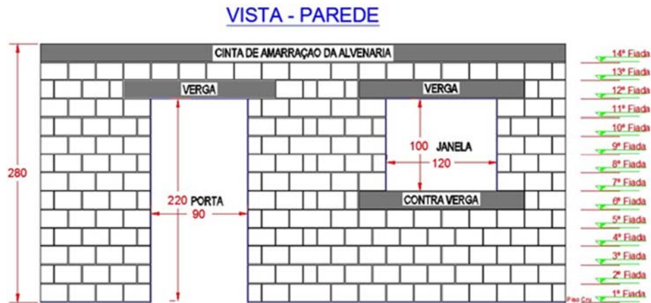
Figura 18: Vergas e contravergas executadas em pré-moldados
