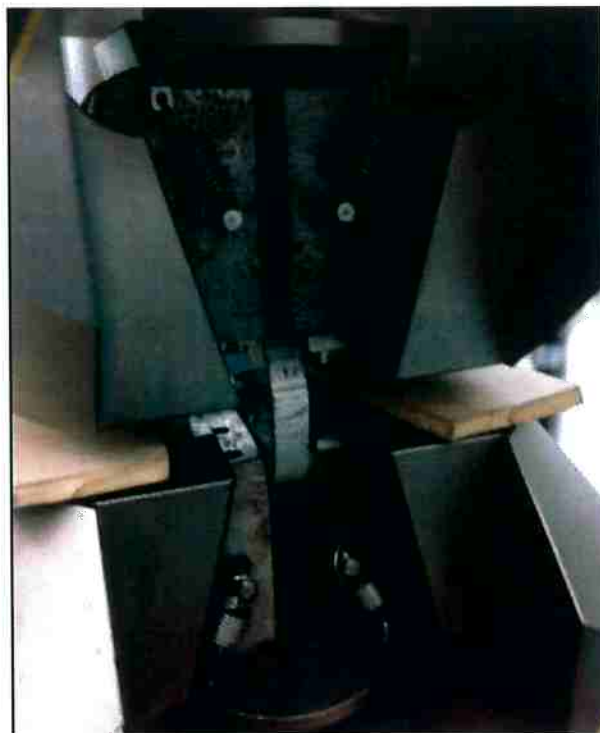
Figura 13 - Foto de como a peça foi presa no experimento
