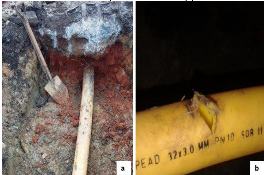
Figura 8 – Ferramenta manual próxima ao local de avaria no duto de gás natural (a) e tipologia da avaria por esta ferramenta (b).
