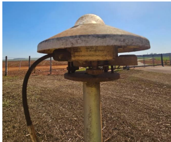
Figura 12 - Piranômetro da estação meteorológica A747, do INMET.
