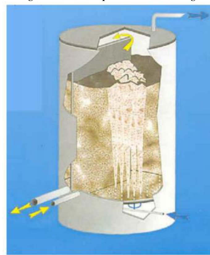
Figura 6 - Modelo esquemático reator Valorga
