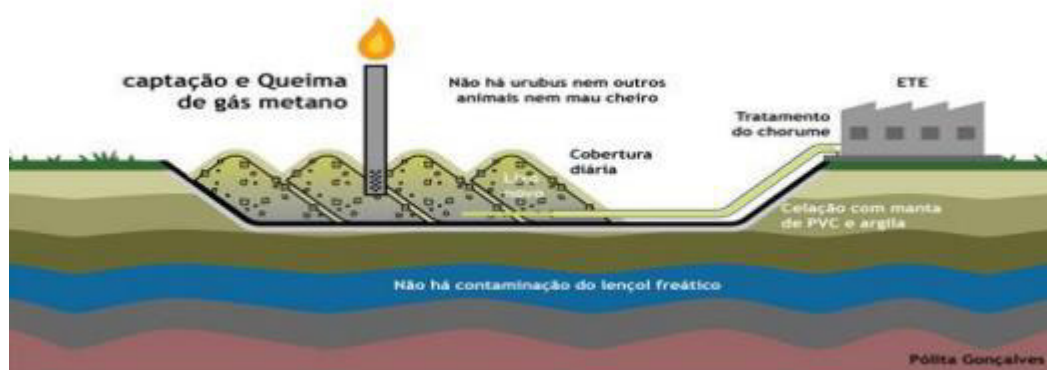
Figura 5 - Exemplo esquematizado de aterro sanitário
