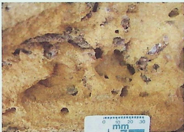
Figura 19: Alvéolos formados em arenito alterado, intensamente perfurado por ação bioêênica. Ponto SU.06. Amostra SU.06B.
