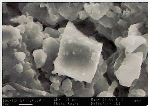
Figura 40: Grãos com formas sugestivas de feldspato. EED revelou Si, Al, O e K. Amostra SU.05E, detector SE1.
