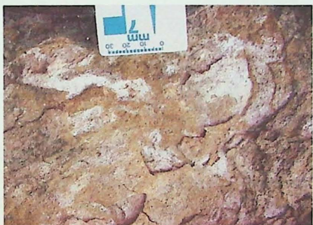
Figura 15: Material pulverulento branco associado a processo de descamação do arenito, Ponto SU.05, amostra SU.05MD. Na imagem à direita, detalhe da destruição de pinturas rupestres pelo processo de descamamento no teto da Lapa Ponciano. Ponto GU.02.
