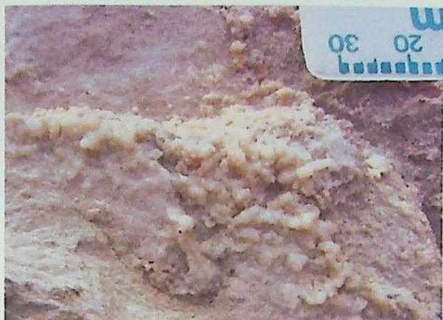
Figura 13: Incrustação sobre o arenito, de coloração bege e hábito botrioidal. Ponto SU.05, amostra SU.05MA
