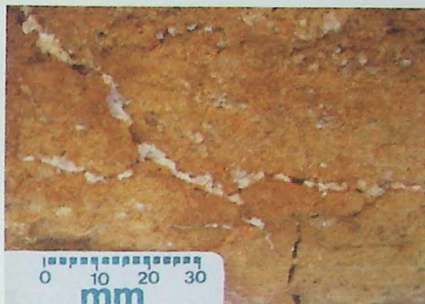
Figura 14: Incrustação de material branco preenchendo microfraturas de arenito alterado. Ponto SU.06, amostra SU.06MB
