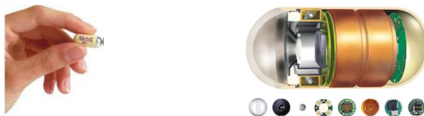
Figura 2: (à esquerda) CE, e (à direita) respectivos componentes contidos numa CE: cúpula (dome) óptica, suporte físico para as lentes, lente (com baixa distância focal), LEDs de luz branca para iluminação, sensor para aquisição de imagens, baterias de óxido de prata para alimentação, um emissor de radiofrequência (RF) para transmissão sem fios das imagens e uma antena [18].
