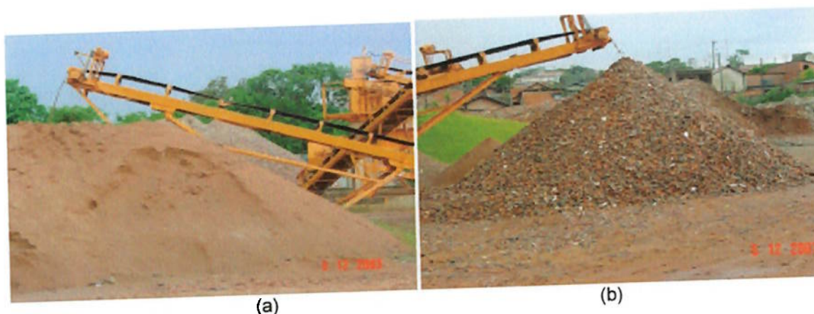
Figura 6.9: Materiais produzidos na usina de reciclagem de Piracibaca/SP. a) Areia reciclada para assentamento de tijolos. b) Agregado graúdo reciclado. Fonte: Miranda (2005).
