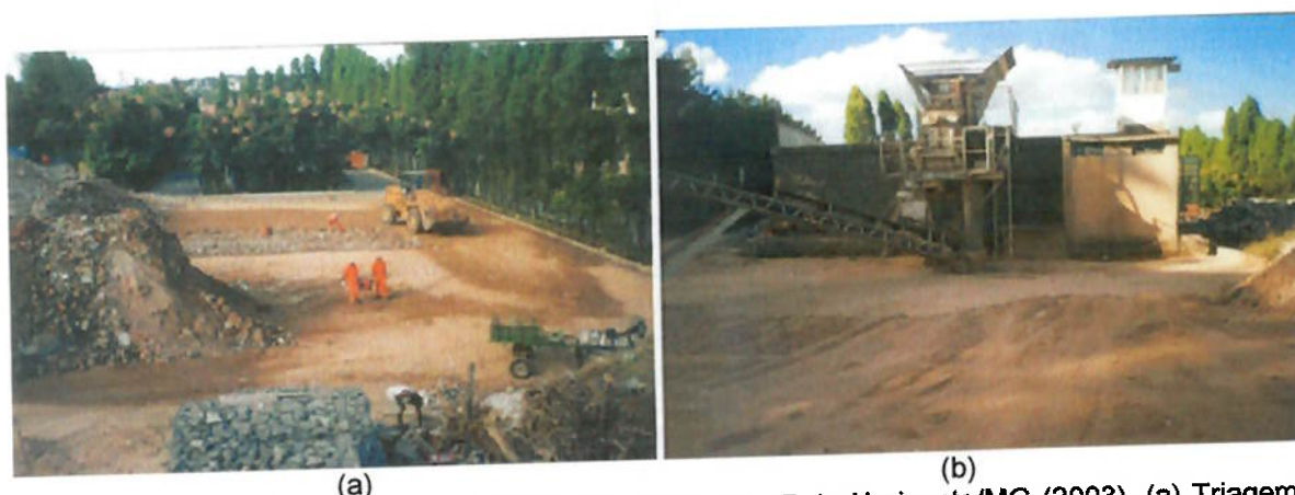
Figura 6.2: Usina de reciclagem de RCC, em Pampulha, Belo Horizonte/MG (2003). (a) Triagem de RCC. (b) Britador de impacto. Fonte: MIRANDA (2005).
