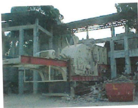
Figura 6.5: a) Detalhe da parte do britador de impacto. b) Detalhe do equipamento de separação magnética. Fonte Miranda (2005).
