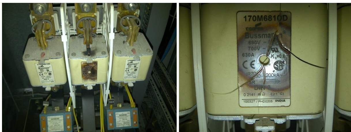
Figura 11 – Fusível danificado por harmônicos de corrente.
