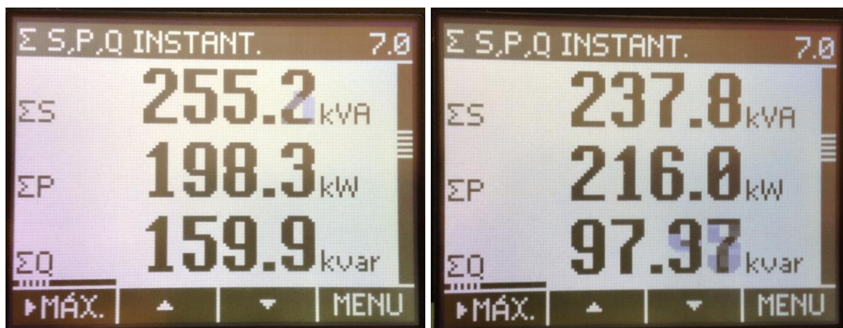
Figura 53 – Multimedidor com a indicação das potências e fator de potência em 0,78.
