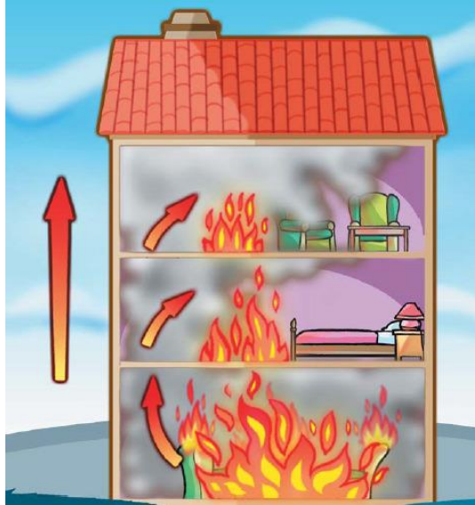
Figura 3 – Propagação do calor por convecção
