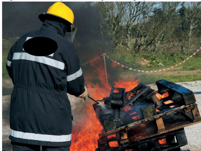
Figura 8 – Exemplo de extinção do fogo por resfriamento.
