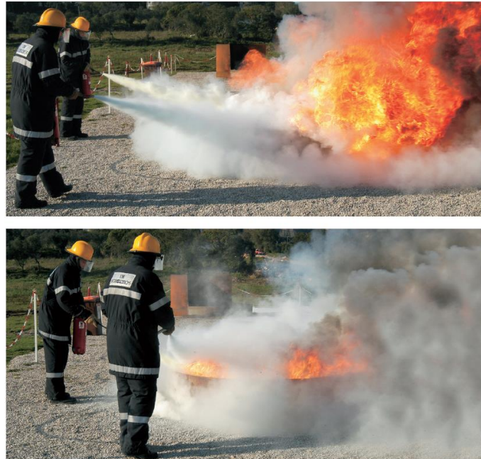
Figura 9 – Exemplo de extinção do fogo pela ruptura da reação em cadeia.
