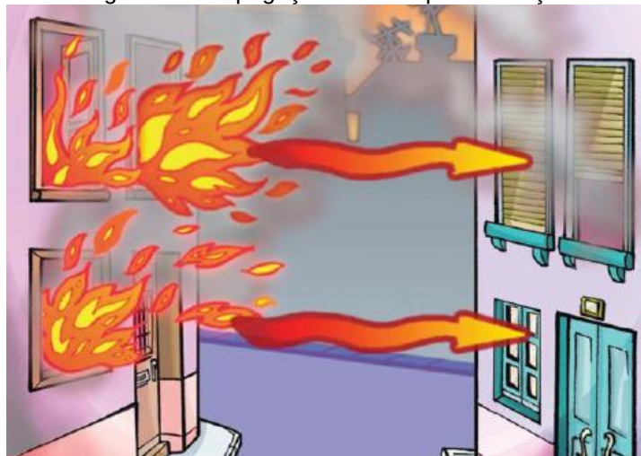
Figura 4 – Propagação do calor por irradiação
