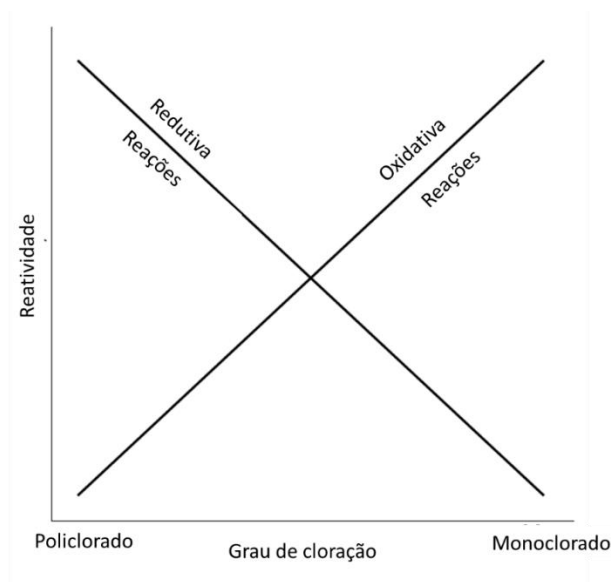
Figura 5 - Tendências relativas de reações microbianas oxidativas versus redutivas em função da cloração.
