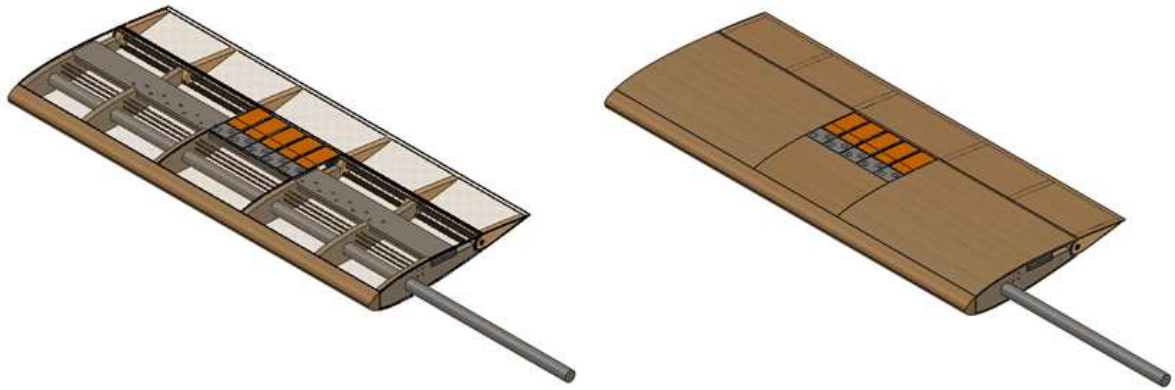
Figura 1 - Atuadores piezoelétricos em estrutura de um aerofólio (ALARCON, 2010)
