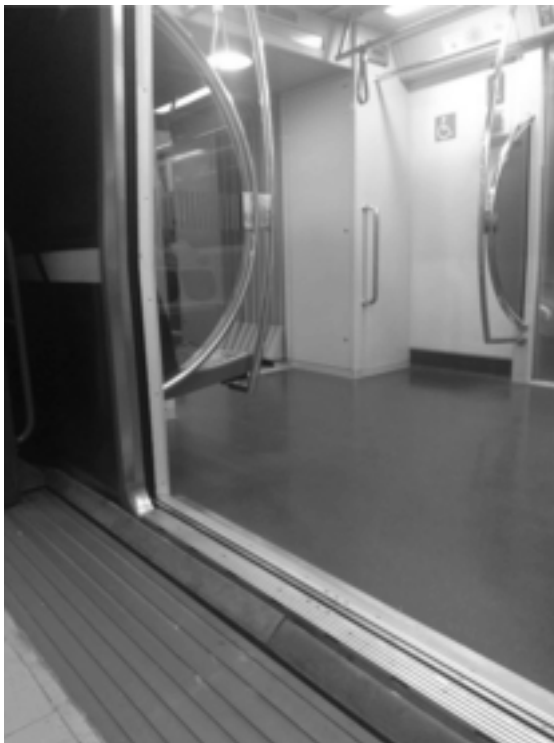
Imagem 8 (esq.). Detalhe de projeto que auxilia a vencer o vão entre trem e plataforma. Autoria própria.
