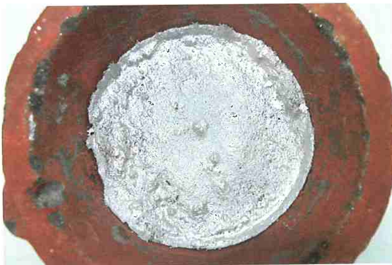
Figura 9 – Vista superior do material retido no filtro, e presença de inclusões na superfície.
