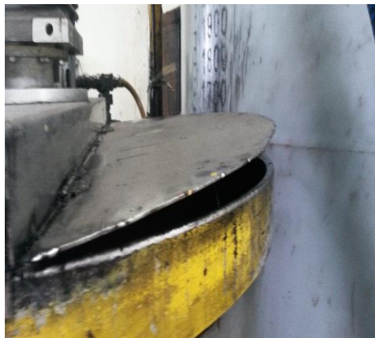
Figura 16: Tampa de inspeção do tanque de gaseificação
