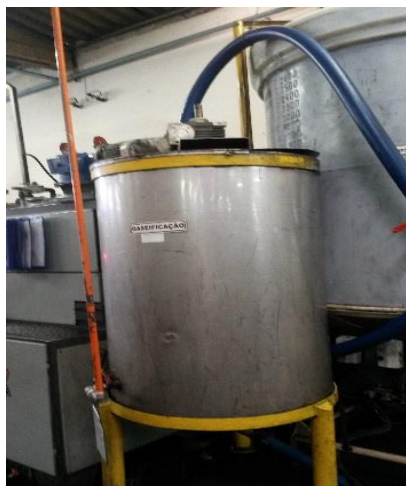
Figura 15: Tanque de gaseificação (tanque balança)
