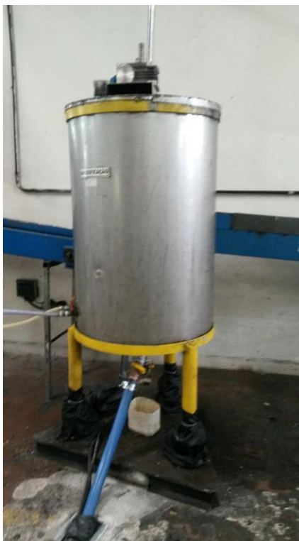
Figura 12: Tanque de gaseificação.
