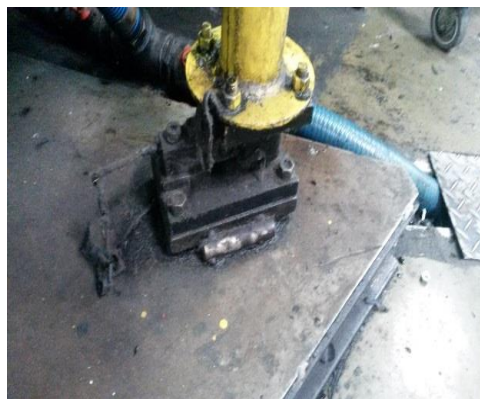
Figura 16: Tampa de inspeção do tanque de gaseificação
