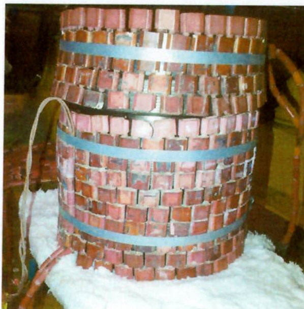
Figura 4.9 - Montagem das Resistências Elétrica para realização do alívio de tensões pós soldagem.
