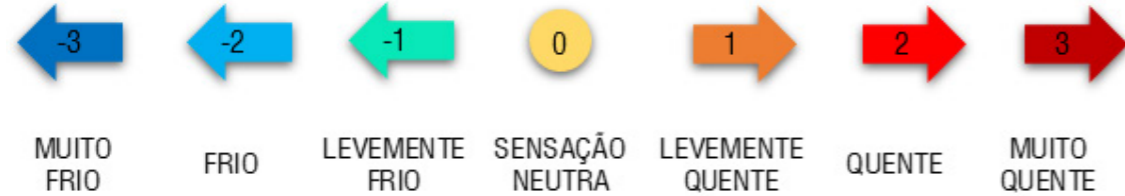
Figura 37: Escala de valores atribuída às sensações de frio e calor pelo Voto Médio Predito (Fanger)
