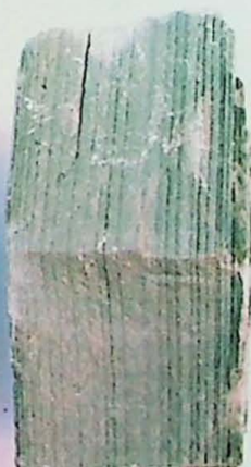
FOTO 18 e 19 – Calcário, antes e depois, com alteração de cor e fissura após a experiência.
