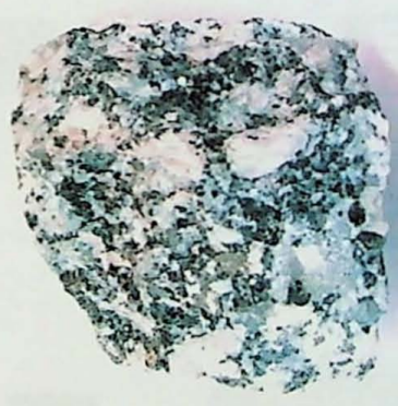
FOTOS 14 e 15 – Granito submetido às mesmas intempéries da experiência acima, sem alterações perceptíveis
