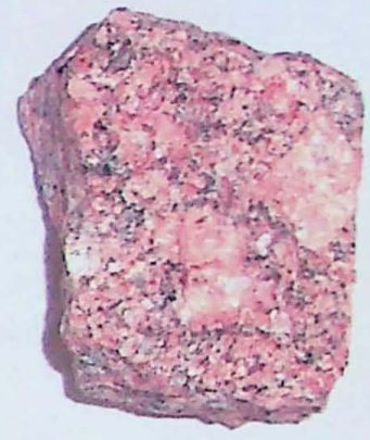
FOTOS 12 e 13 – Granito antes e depois de ser submetido à variações de temperatura; nota-se a perda do brilho original.
