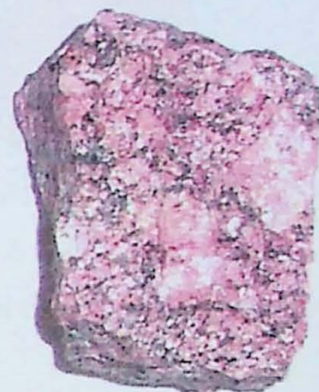
FOTOS 12 e 13 – Granito antes e depois de ser submetido à variações de temperatura; nota-se a perda do brilho original.
