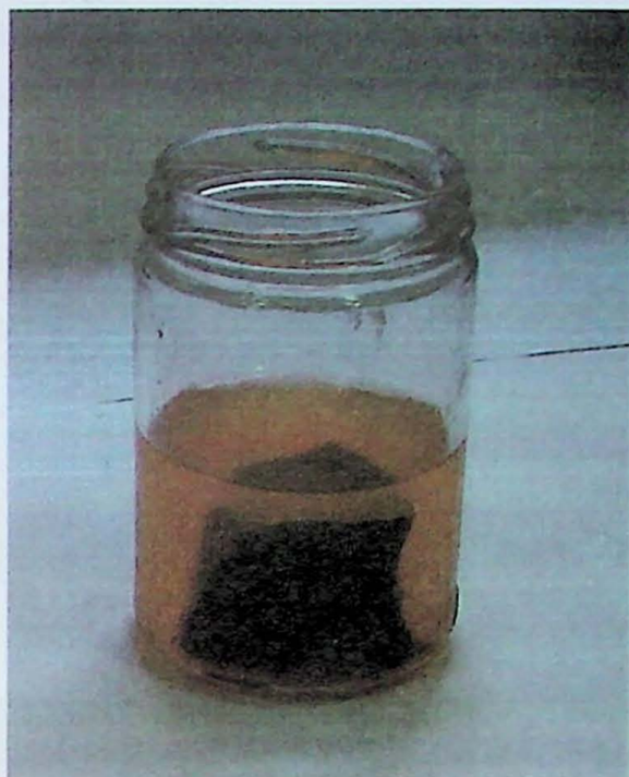
FOTOS 22 e 23 – As rochas foram submetidas a um banho de vinagre por cerca de dois meses. Reparamos que a água ficou turva, simulando a ação do intemperismo químico.
