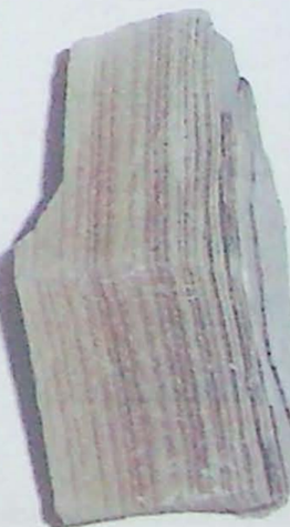
FOTO 18 e 19 – Calcário, antes e depois, com alteração de cor e fissura após a experiência.
