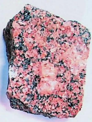
FOTOS 12 e 13 – Granito antes e depois de ser submetido à variações de temperatura; nota-se a perda do brilho original.
