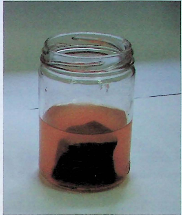
FOTOS 22 e 23 – As rochas foram submetidas a um banho de vinagre por cerca de dois meses. Reparamos que a água ficou turva, simulando a ação do intemperismo químico.
