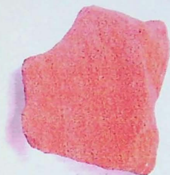
FOTO 16 e 17 – Arenito vermelho submetido à intempéries, com desgaste superficial.
