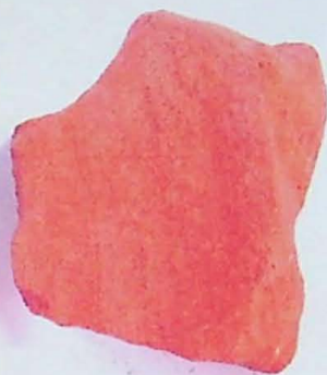
FOTO 16 e 17 – Arenito vermelho submetido à intempéries, com desgaste superficial.
