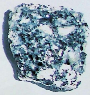
FOTOS 14 e 15 – Granito submetido às mesmas intempéries da experiência acima, sem alterações perceptíveis
