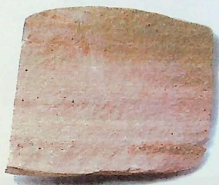
FOTO 16 e 17 – Arenito vermelho submetido à intempéries, com desgaste superficial.
