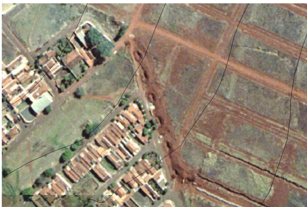
Figura 21 – Erosão por escoamento superficial (Área Parcelada, 2001)
