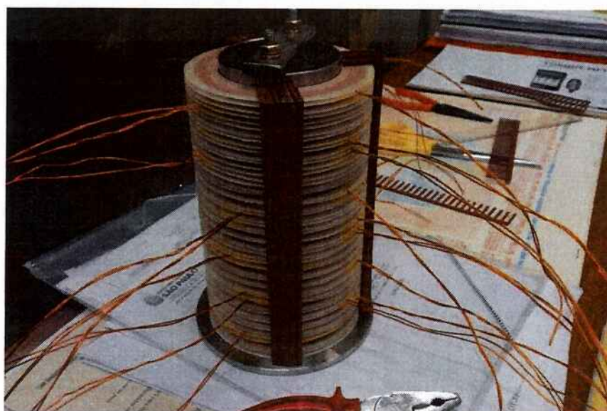
Figura 12.15 – Foto das bobinas encaixadas em alguns pentes do estator
