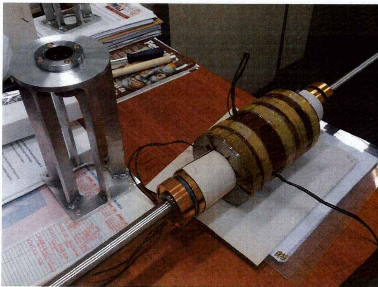
Figura 12.23 – Processo de montagem do gerador na estrutura de suporte
