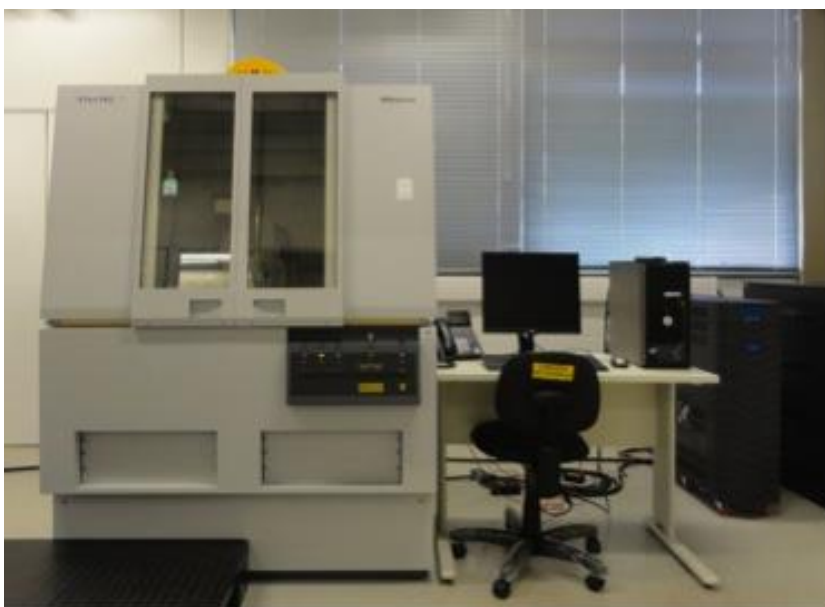
Figura 3.4: Difratorômetro Panalytical utilizado para realização dos ensaios de difração de raio-X no laboratório LNNano dentro do CNPEM.
