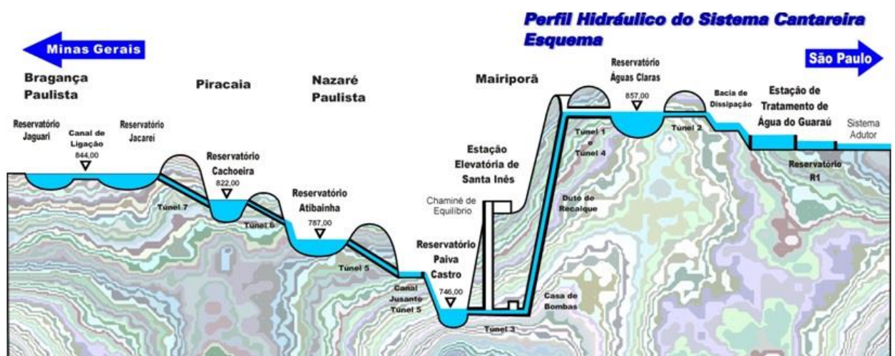
Figura 5b: Perfil Hidráulico do Sistema Cantareira. (Fonte: SUASSUNA, 2017)
