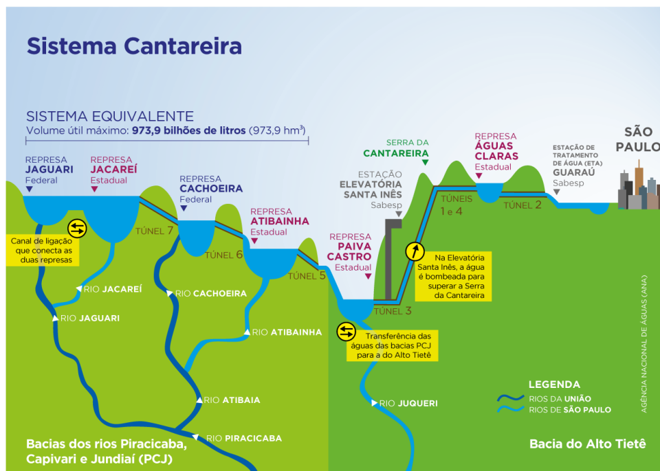
Figura 5a: Representação Esquemática do Sistema Cantareira (Fonte: ANA, 2017)
