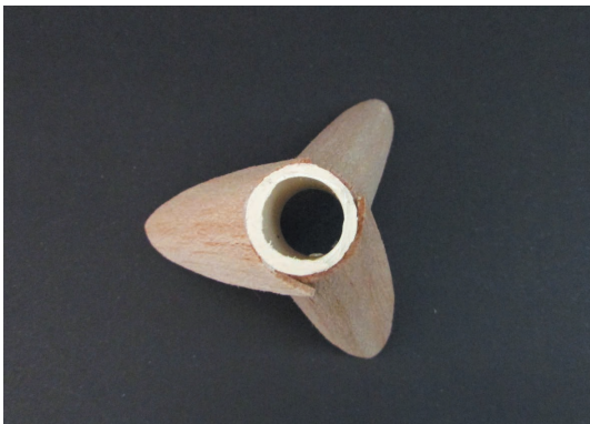
Modelo inicial em madeira balsa e PVC. Vista superior.
