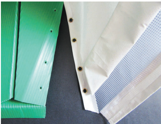
09. Alinhar os furos da peça plástica com os ilhóses da peça de tecido.
