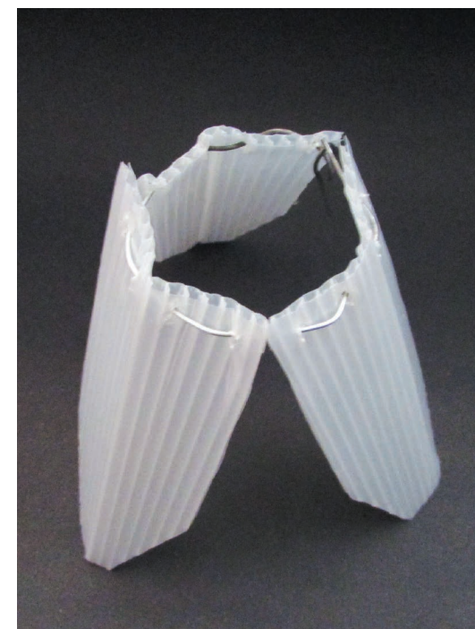
Modelo com arame prendendo as placas. Vista superior.
