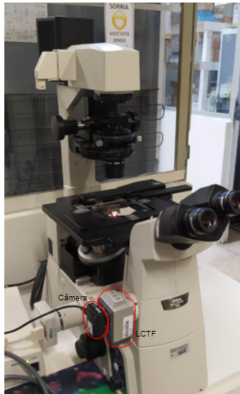
Figura 6 – Foto do microscópio e do acoplamento da câmera monocromática e da LCTF
