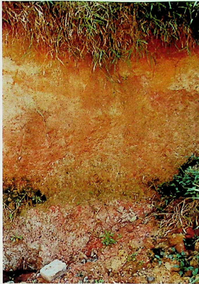
Foto 11 – Contato solo mais arenosos (acima) com o mais argilosos no bairro Rio Comprido
