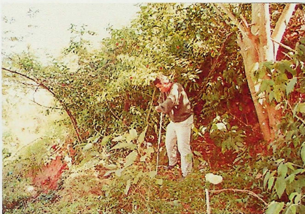
Foto 10 – Sondagem a trado para amostragem
