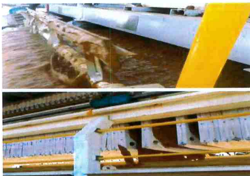
Figura 24: Detalhe do processo de flotação (acima) e filtração em prensa (abaixo) para produção do concentrado de minério (Lynas, 2011).
