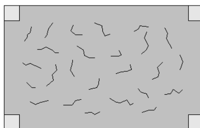
Figura 41. Manifestação típica de fissuras de retração hidráulica e contração térmica. (HELENE; PEREIRA, 2007)
