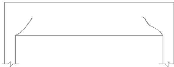
Figura 22. Manifestação típica de fissuras devido às forças cortantes. (HELENE; PEREIRA, 2007)
