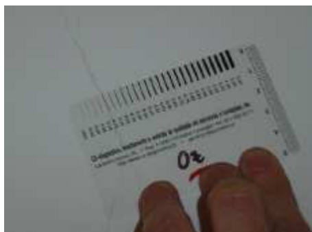
Figura 10. Medição de abertura de fissura ( http://www.oz-diagnostico.pt ).
