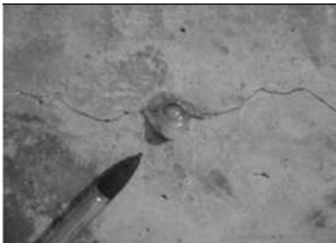
Figura 3. Gel resultante da reação álcali-agregado. (HASPARYK, DALMOLIN, MONTEIRO, 2006)
