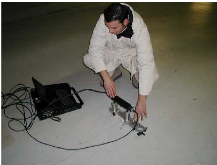
Figura 13. Medição de profundidade de fissura ( http://www.oz-diagnostico.pt ).
