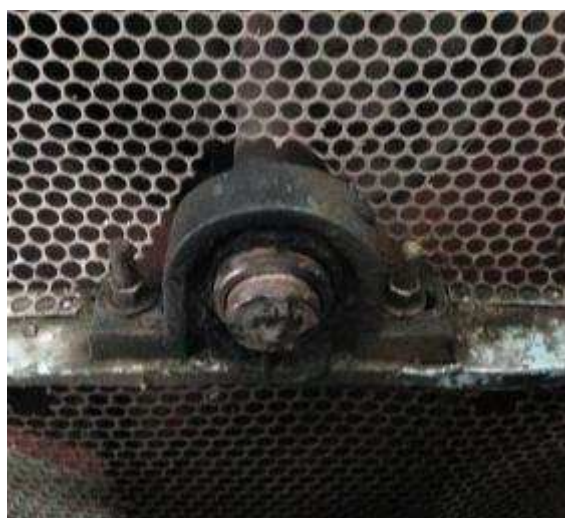
Figura 13 – Eixo central da voluta do ventilador exposto, parte rotativa.
