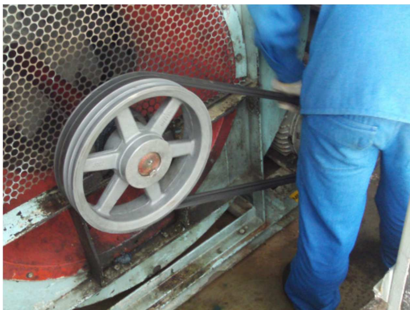
Figura 14 – Correia da voluta do ventilador exposto, parte rotativa.
