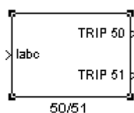
Figura 30 – Representação do relé de sobrecorrente trifásico.
