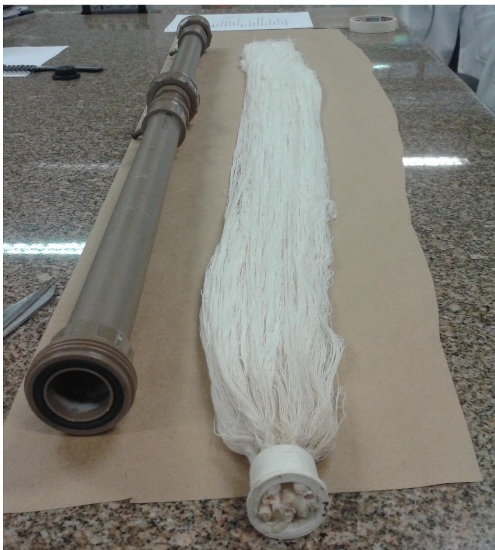
Figura 17 - Leito de fibra flexível de poliéster e a tubulação de PVC onde o mesmo foi inserido
