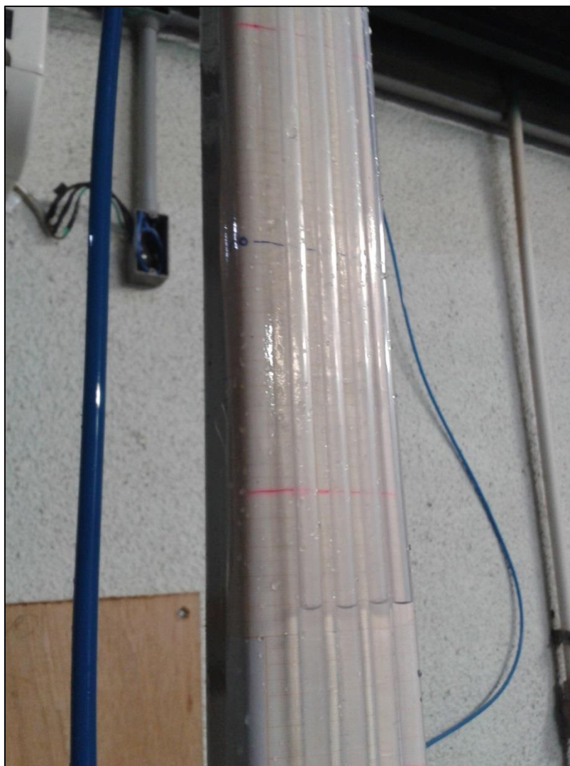
Figura 19 - Foto de um trecho da tomada de pressão em metros de coluna de água
