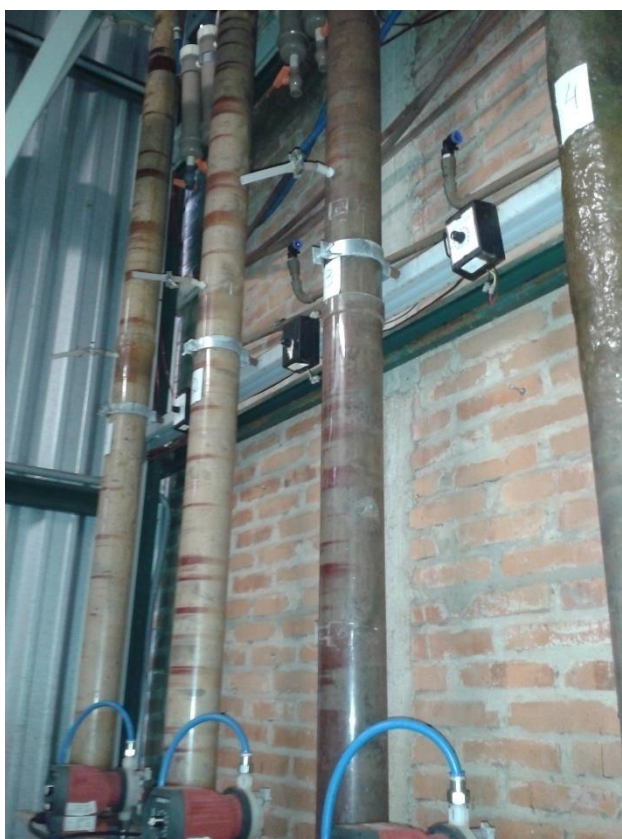
Figura 7 - Foto do reator anaeróbio ascendente de fibra flexível estudado por PELEGRINO (2015)
