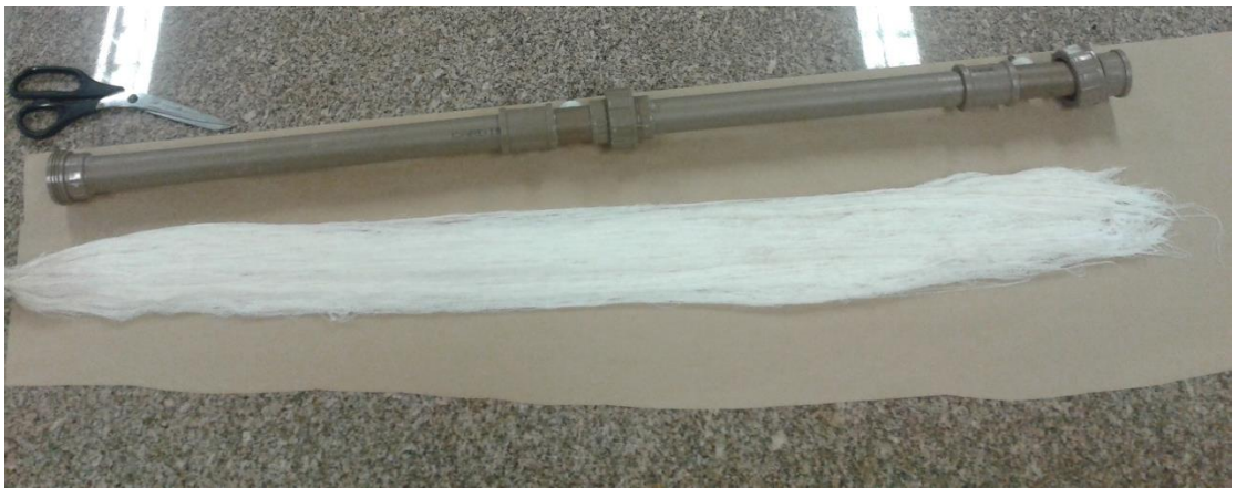
Figura 16 – Recuperação das fibras de poliéster após o uso por FAGUNDES (2015)
