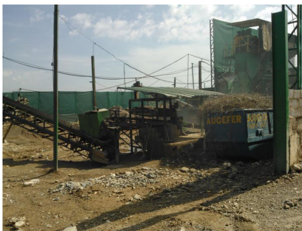
Figura 10 - atividade de reciclagem fixa com sistema de aspersão de água para controle de pó. Imagem: acervo próprio.
