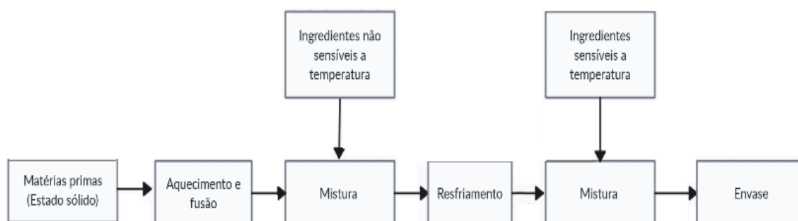
Figura 13 - Fluxograma das etapas da fabricação de um desodorante natural (Adaptado de DANTAS, 2023)
