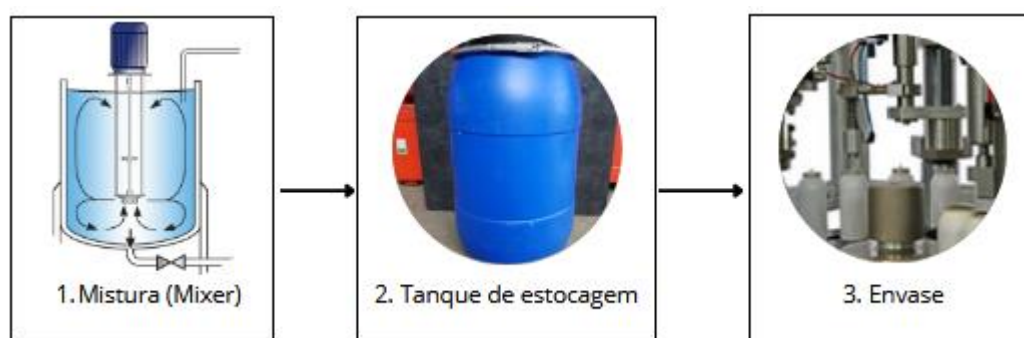
Figura 6- Etapas do processo de fabricação de desodorantes (Adaptado de CHAROENBUNSUPKARN, 2020; SILVERSON, 2016)
