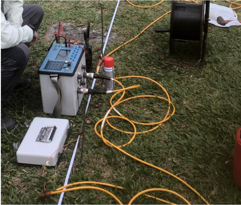
Figura 10: Processo de aquisição de dados ER com equipamento Syscal da fabricante Iris Instruments.
