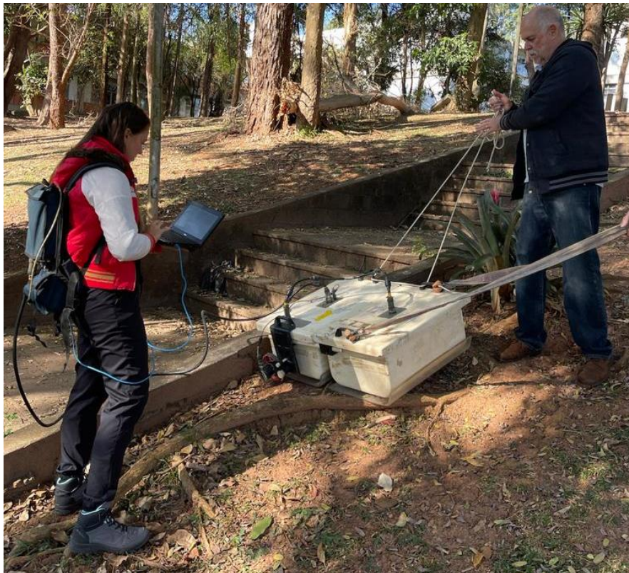
Figura 11: Processo de aquisição de dados GPR com antena de 100 MHz.
