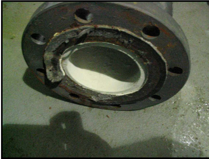
Figura 10 – Incrustação na cor branca em tubulação de água
