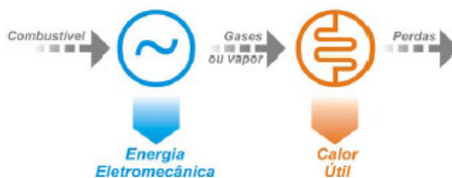
Figura 2.3 – Cogeração do tipo topping . Fonte: BARJA, 2006.
