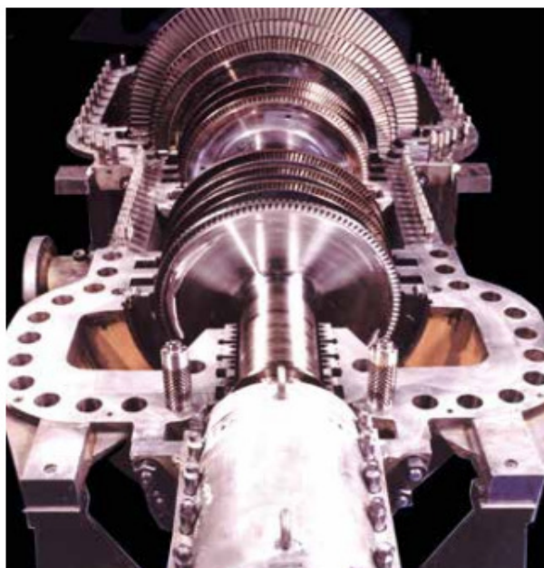
Figura 2.10 – Turbina de contrapressão de 25 MW. Fonte: SIEMENS, 2017.
