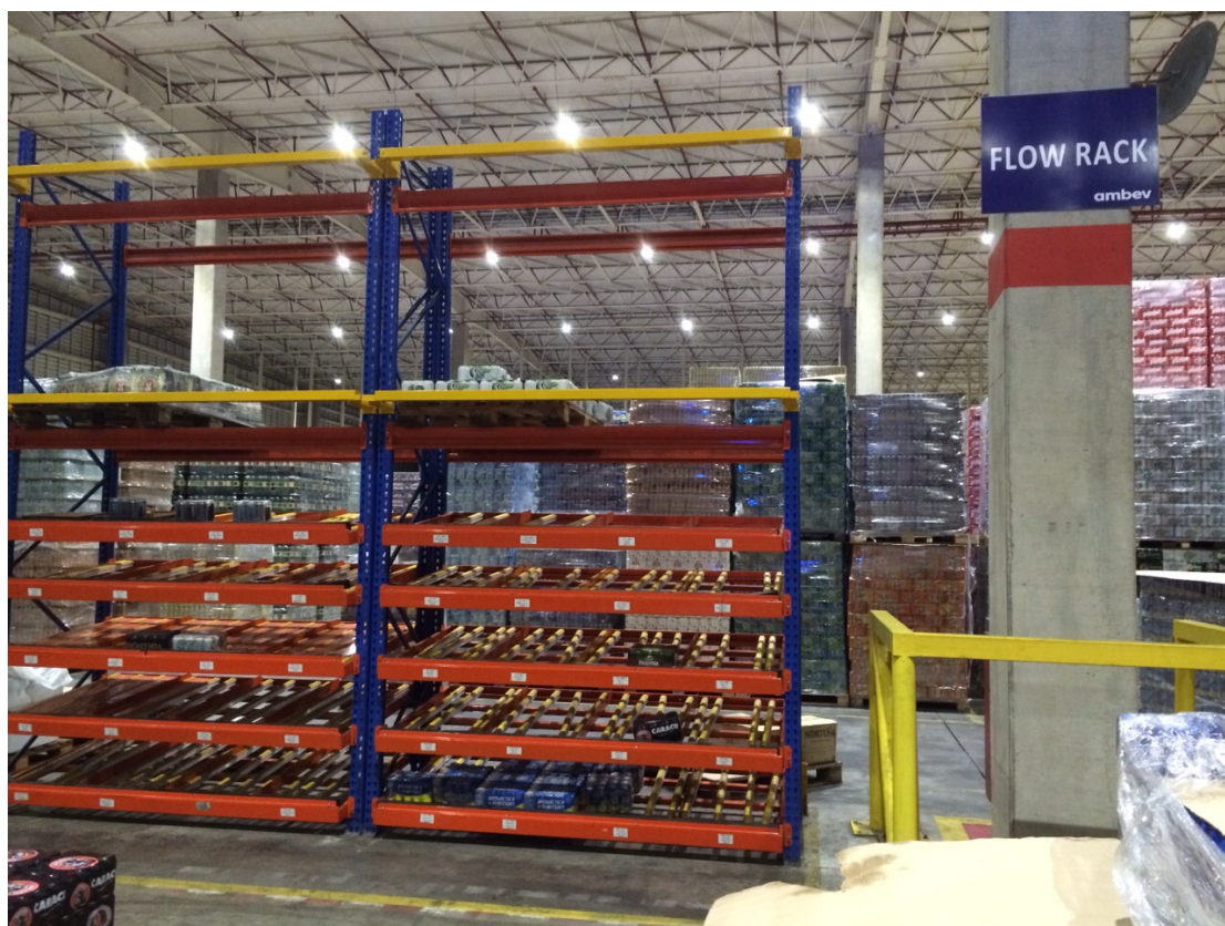
Figura 19- Flow rack. Nota-se que está subutilizado
