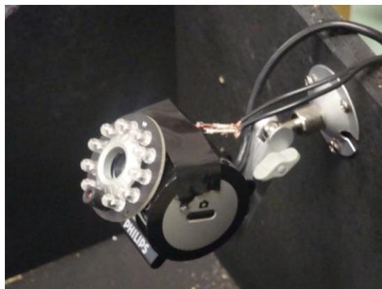
**Figura 3-7 Câmera Philips SPC900NC acoplada no protótipo de testes**
