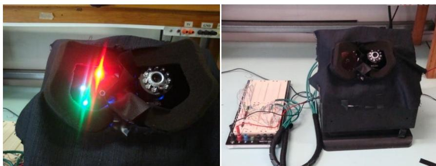
**Figura 3-9 a) Protótipo desenvolvido para análise da pupila do voluntário b) Protótipo para análise da pupila e o circuito eletrônico de iluminação feito em *protoboard***
