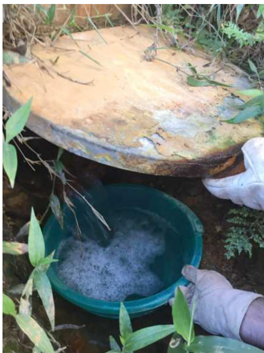
Figura 9 – Medição da vazão proveniente do dreno profundo
