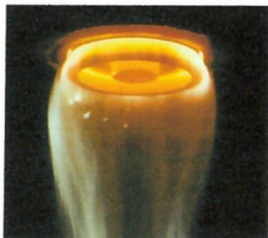
Figura 10 - Fibragem lã de vidro - fonte: catálogo Saint-Gobain Isover
