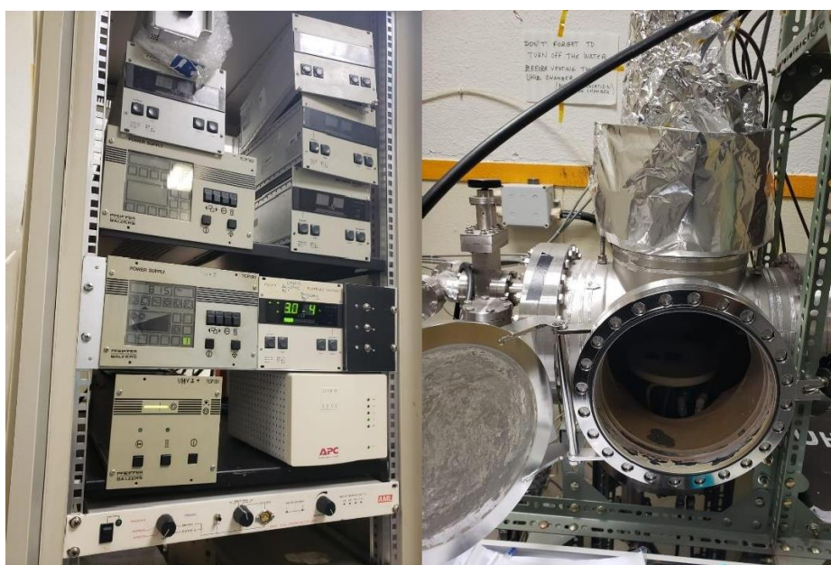
Figura 31 - (a) Equipamentos de controle de frequência e pressão da UHV2 (b) Câmara de vácuo de deposição (Foto do autor)
