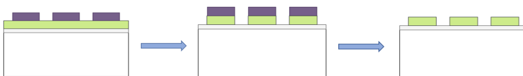
Figura 29 - Esquema das etapas seguintes à fotolitografia (Elaborado pelo autor)
