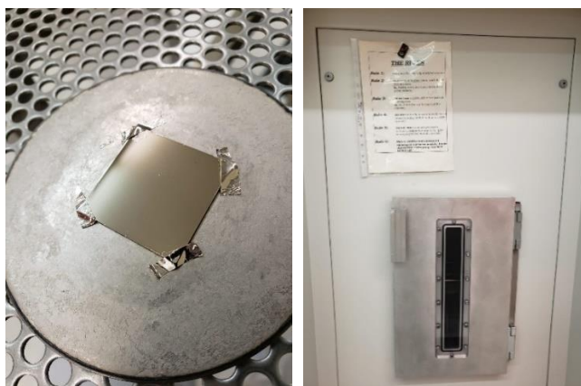
Figura 35 – (a) Amostra pós metalização (b) Máquina Nordiko 7000 (Foto do autor)
