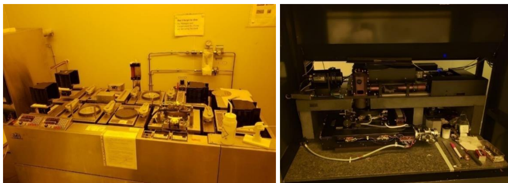
Figura 24 – (a) Sistema de rastreamento SVG (b) Laser DWL de luz UV (Foto do autor)
