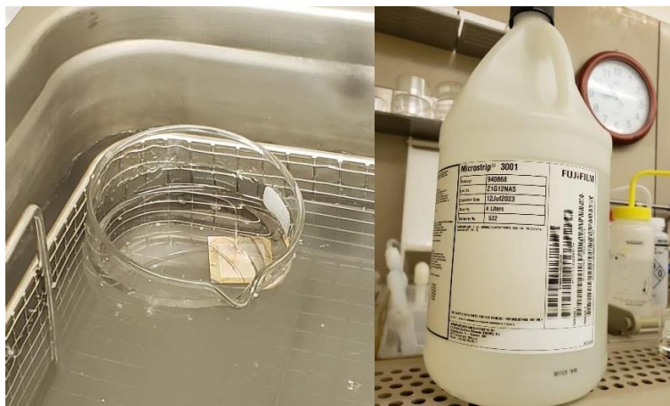
Figura 28 - (a) Amostra sob banho ultrassônico a 65°C (b) Microstrip® 3001 (Foto do autor)
