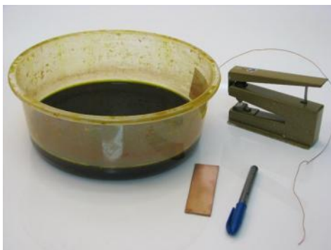
Figura 1 - Kit de Confecção de Circuitos
