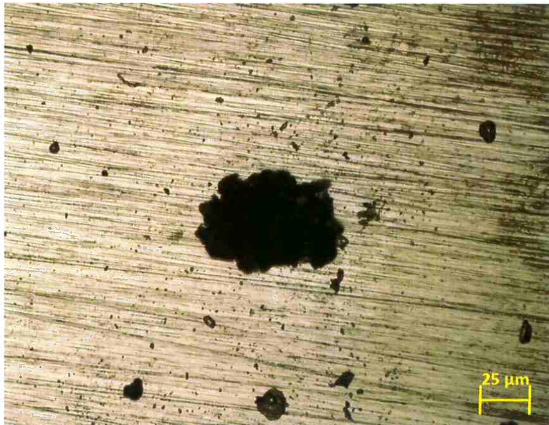
Figura 36: Pite formado em ensaio de polarização potenciodinâmica. Aumento 200x
