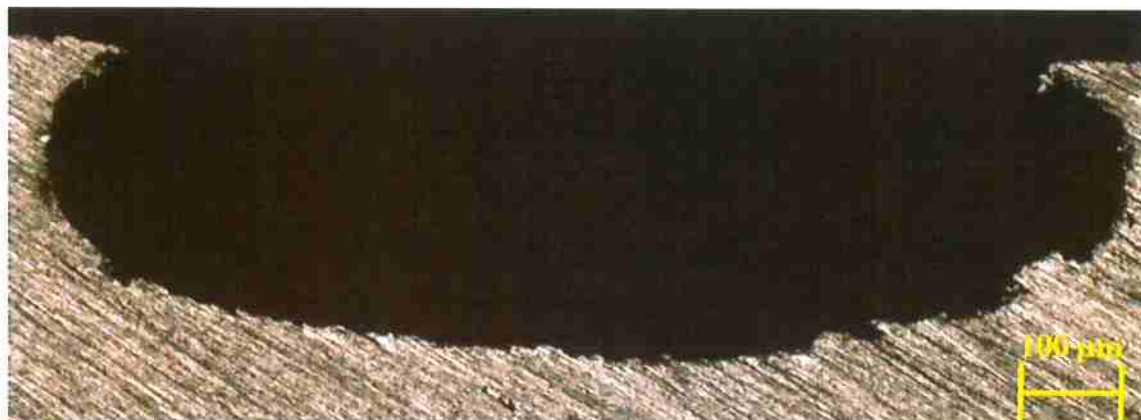
Figura 28: Pite formado em ensaio de imersão em cloreto férrico
