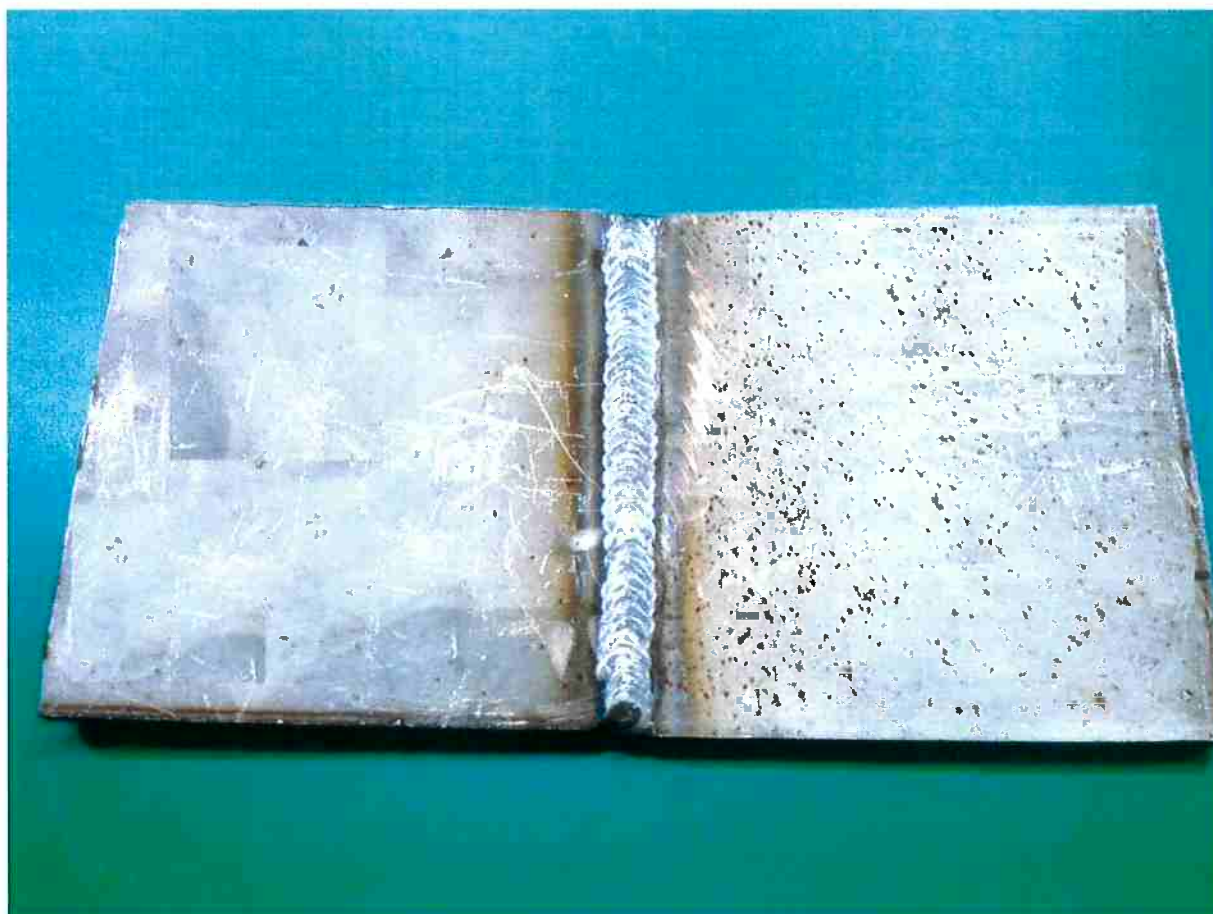
Figura 6 - Chapa de aço inoxidável 304 após a soldagem com consumível 308L
