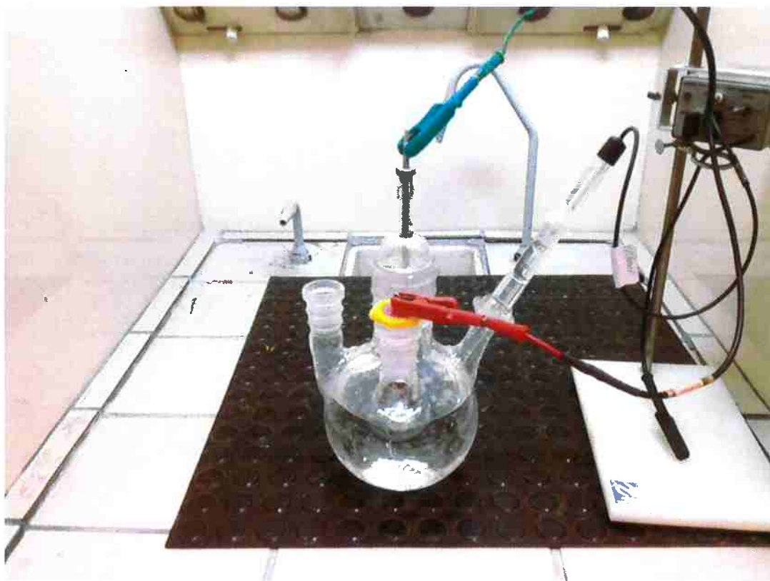
Figura 9: Célula utilizada no ataque eletroquímico
