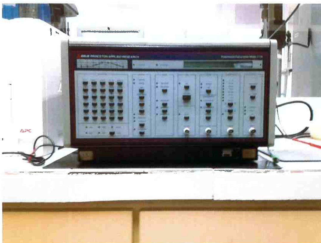
Figura 10: Potenciostato utilizado no ataque eletroquímico
