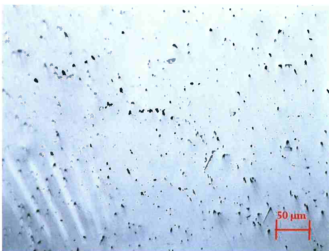
Figura 15: Micrografia do cordão de solda para realização da prática A sem ataque. Aumento 100x
