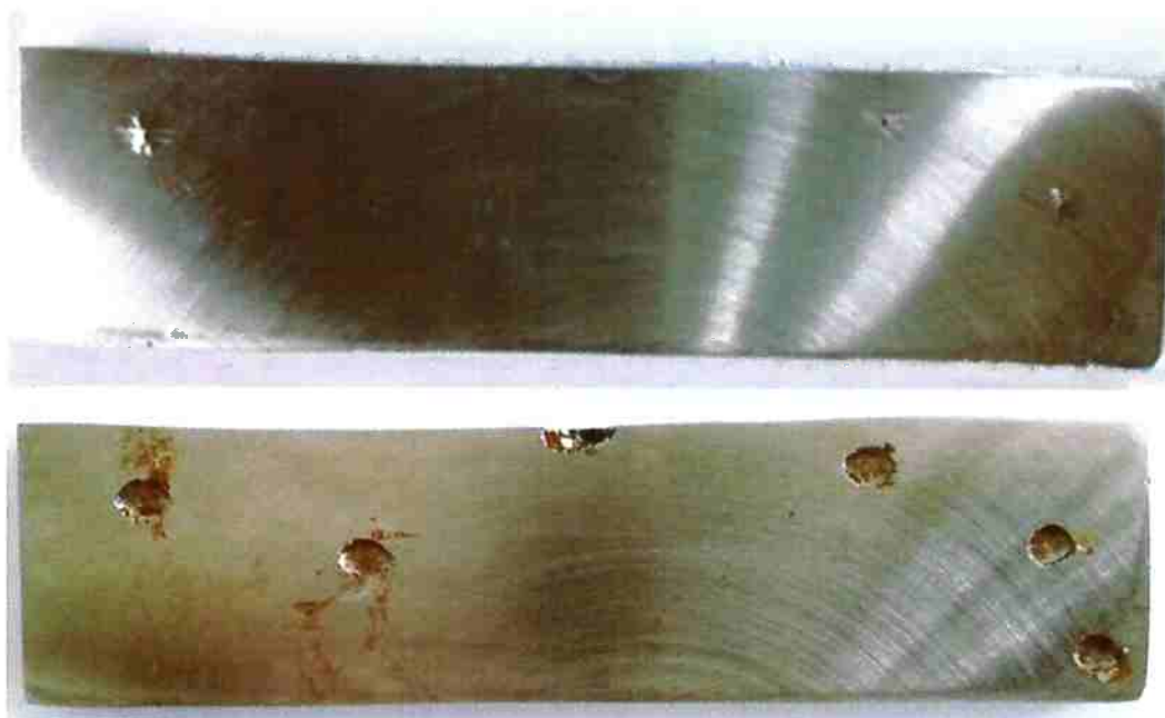
Figura 30: Superfície do corpo de prova 2 após ensaio de imersão em cloreto férrico. Presença do filme que abriga o pite e após a remoção do filme
