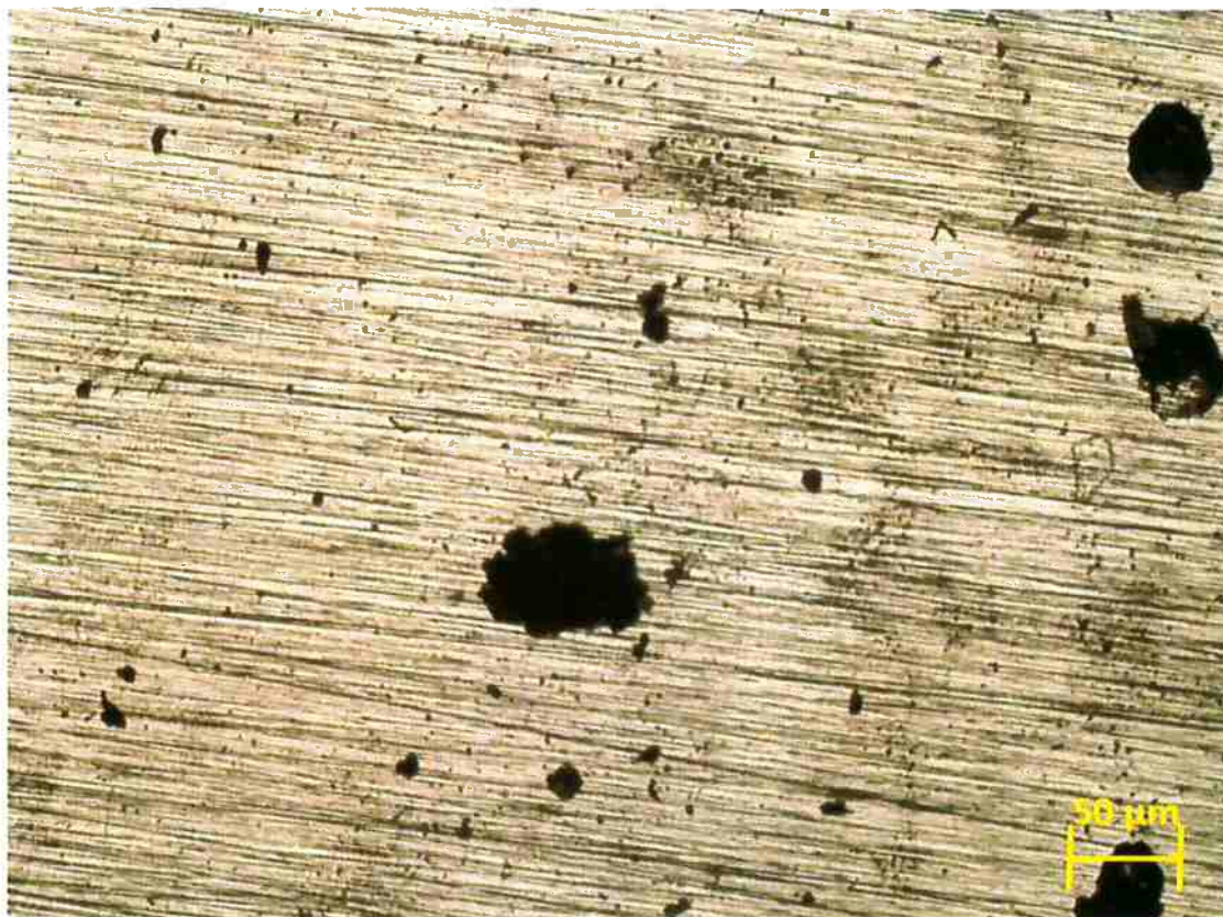
Figura 35: Pite formado em ensaio de polarização potenciodinâmica. Aumento 100x
