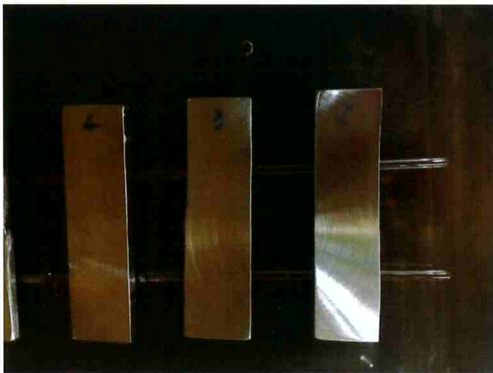
Figura 12: Interior do recipiente e disposição dos corpos de prova para ensaio de Imersão em Cloreto Férrico
